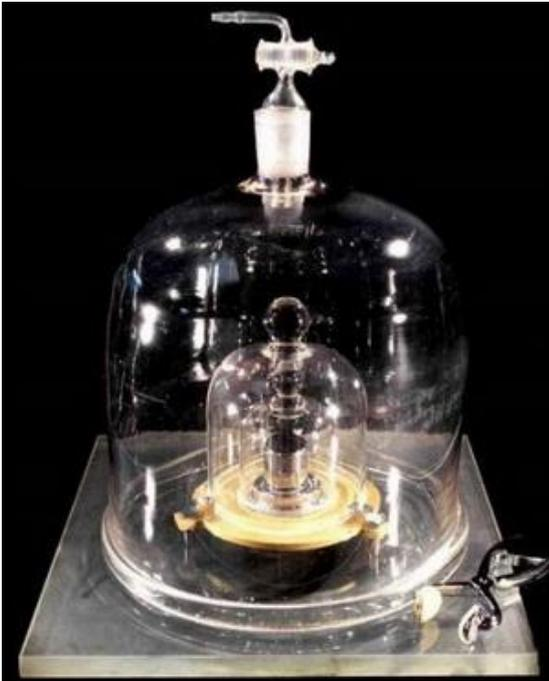
*Le prototype international du kilogramme (alliage de platine et d'iridium) défini en 1889*
